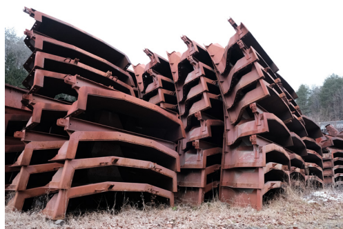
▲ SK ブラストの資材置き場。消波ブロックの型枠が置かれている
